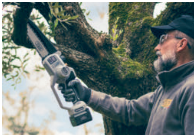
Potatore a catena KVS8000, Catena 1/4x1.148 maglie, barra da 8", alimentato da V.Battery da 21,6 V.
