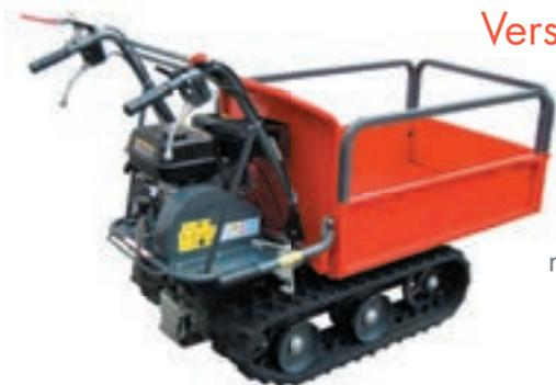
Il minitransporter 09710 ha motore Loncin da 196 cc e 6,5 Hp di potenza, trasmissione con tre marce in avanti ed una retromarcia, capacità di carico di 300 kg, lunghezza del cassone 910-1040 mm, larghezza 600-860 mm, altezza 204 mm. Ribaltamento manuale con pistone, larghezza cingolo 180 mm. Con molle tendi-cingolo. E l'affidabilità firmata Blue Bird.
