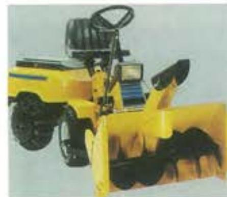
ficili seguendo dislivelli e collinette, rag- girando facilmente ogni tipo di ostacolo. Disponibile anche con trasmissione idro- statica, Parco monta un motore Briggs & Stratton da 12 o 16 HP, frizione, freni e cambio a 5 velocità di avanzamento più retromarcia, avviamento elettrico.
