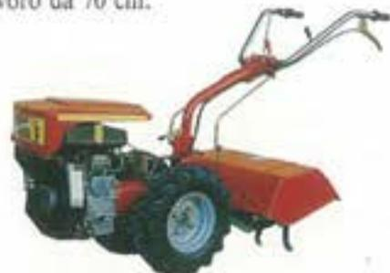
Le caratteristiche della macchina sono: motore 4 tempi da 10 HP; avviamento a strappo; frizione conica a secco; trasmissioni ad ingranaggi a bagno d'olio; presa di potenza a 965 giri/minuto; cambio a 5 velocità con tre marce avanti e due retro-marce; ruote Tractor 4,00-8; fresa registrabile cm 55.
