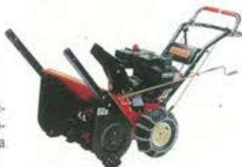
motori, forniti da Briggs & Stratton per il modello a due tempi 3/55 e da Tecumseh per tutti gli altri, semoventi a cingoli monoasse o a ruote motrici con catene. Per questi variano le potenze, 5-8-10-12 HP, e variano di conseguenza le larghez- ze di lavoro, 50-59-64-69-81 cm e i pesi, 62-86-90-134-150 kg.
