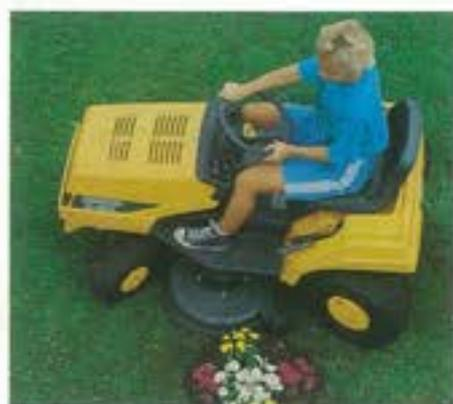
potevano dunque mancare i modelli, per la precisione si tratta dei più potenti, che hanno la possibilità di trasformarsi al bisogno in ottime macchine per spalare la neve. L'immagine che presentiamo illustra uno di questi trattorini tutt'fare, il "12-100 E" equipaggiato con motore Briggs & Stratton monocilindrico da 12 HP; cambio a 6 marce avanti più la retromarce, ha quattro ruote sterzanti e pesa 201 kg.
