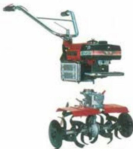
Le caratteristiche di questo modello: motore Minarelli I-150 KW 5,15-CV7, funzionante a miscela di benzina-olio al 3%, completo di avviamento autoavvolgente e dispositivo antinfortunistico per arresto del motore; trasmissione in bagno d'olio; cambio a 3 velocità + retromarcia; frizione automatica a secco, a richiesta con comando manuale; filtro aria in bagno d'olio; stegole regolabili ed orientabili in tutte le posizioni; peso kg 70.
