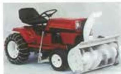
HP, che presentiamo, e da 12 HP. Equipaggiato con motore a scoppio 4 tempi, bicilindrico Briggs & Stratton, è un trattorino la cui potenza permette una efficace spazzatura della neve.
