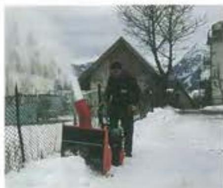
Motore: 4 tempi da 3,5 a 6 HP con possi- bilità di avviamento elettrico. Cambio: ad ingranaggi in bagno d'olio, con tre velocità, due in avanti e una in re- tromarcia nella versione con lo spazzane- ve.
