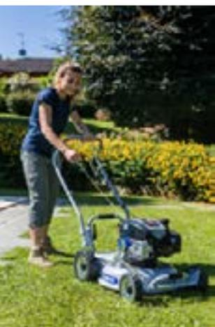
**PIANO GRIN.** «Grin PM53A KW è costruita sul collaudatissimo telaio **Grin**», spiega il responsabile commerciale e marketing Daniele Bianchi, «monta l'apprezzatissimo motore professionale Kawasaki FJ180V KAI da 179 cc dotato di un sistema di lubrificazione forzata, che permette il taglio anche su pendenze importanti, senza problemi di pescaggio dell'olio. Il gruppo trazione professionale a due velocità, in scatolato di
