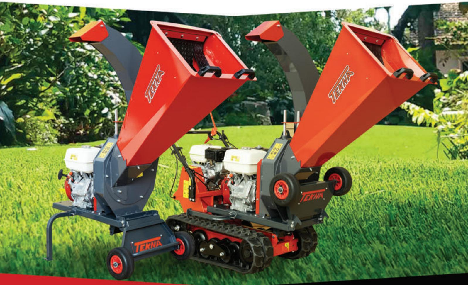
Il Cippatore TEKNA TC08 è una macchina adatta alla triturazione di potature fresche fino ad un diametro max. di rami di 8 cm\*, con possibilità di installazione sulla gamma di motocarriole Tekna.
