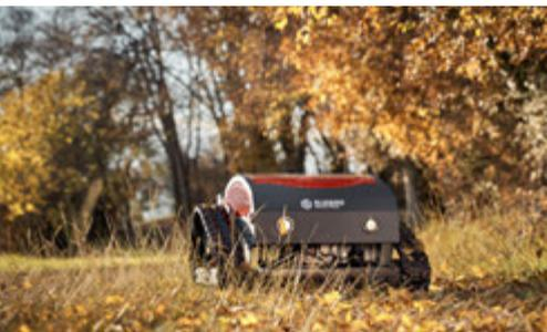
Una delle tante novità del 2023 firmata Blue Bird è il nuovo trinciasarmenti radio-comandato FM 23-53. Unica al mondo nel suo genere, si tratta di una macchina solida e compatta che offre grande potenza nello sfalcio e ottimo controllo nell'avanzamento. Il sistema ibrido è composto da due motori elettrici a batteria che permettono il movimento dei cingoli e da un potente motore Loncin da 224 cc che controlla la lama di
