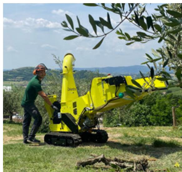
Su Zakandra la regolazione della velocità ed inversione del rullo di alimentazione avviene attraverso settaggio manuale della valvola oleodinamica ed interruttori di posizione elettrici. Zakandra raggiunge una Velocità massima di a 2,5 km/h. e pesa 550 kg. La tramoggia ripieghevole in due posizioni agevola le manovre e riduce gli ingombri.
