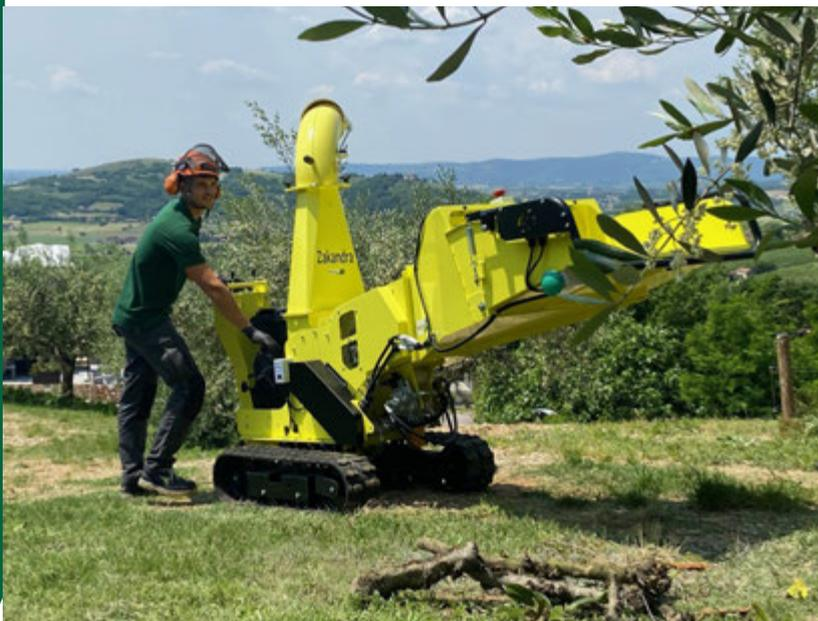
in pendenza. Con un apposito kit di montaggio e previo smontaggio del cassone, è possibile adattare il cippatore su tutte le nostre motocarriole cingolate versione TT350 o TT500, rendendo così le due macchine perfettamente compatibili e flessibili nel loro utilizzo a seconda delle esigenze. A seconda della tipologia e durezza di legno da tritare.
