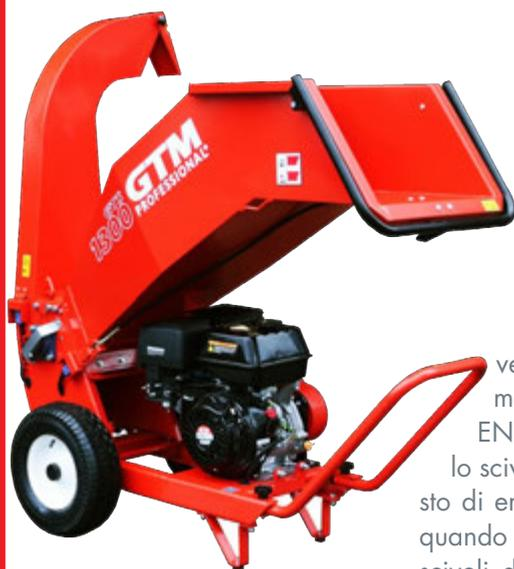
Grazie alle tramogge con bocche di grandi dimensioni, agli scarichi alti e regolabili, viene assicurata massima facilità di utilizzo per ogni tipologia di lavoro. Attraverso la tramoggia di scarico il cippato può essere espulso direttamente in un rimorchio. Il cippato, ridotto facilmente in trucioli di legno sottili, è l'ideale per pacciamatura e compost.
